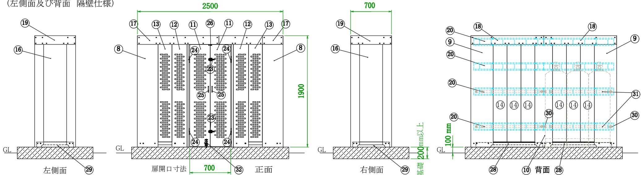
※ 基礎との隙間等が出来る则ち隔壁としての機能が十分満たされなない場合がありますので基礎コンクリートのレベルは出来るだけ水平に施工をお願いします。(微調整可能)
