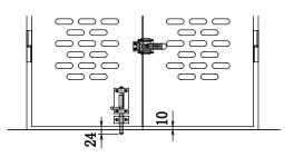
ストローク約44丸落とし用ビス M5ナベ×6丸落とし部詳細M6×15 118個<br/>M6×12 46個
