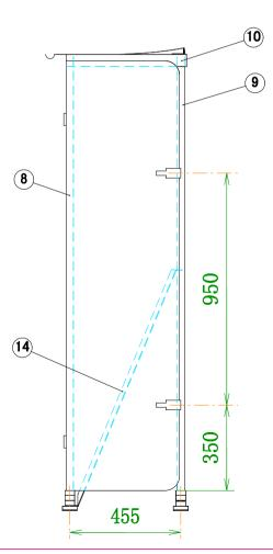
\*震度7(818gal)程度の強い地震でも ガスボンベを、転倒させない為に必ず ボンベチェーンは上下2本懸けとして 下さい。
