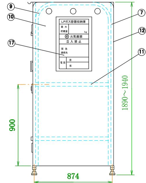
\*震度7(818gal)程度の強い地震でもガスボンベを、転倒させない為に必ずボンベチェーンは上下2本懸けとして下さい。
