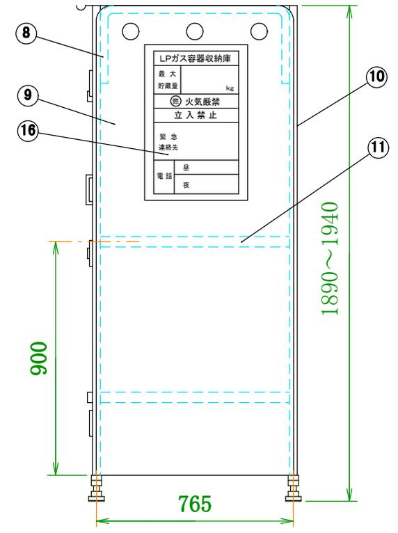
\*震度7(818gal)程度の強い地震でもガスボンベを、転倒させない為に必ずボンベチェーンは上下2本懸けとして下さい。
