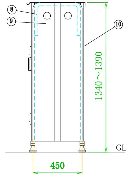
\* 震度7(818gal)程度の強い地震でガスボンベを、転倒させない為に必ずボンベチェーンは上下2本懸けとして下さい。
