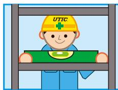
連結完了後、水準器を、上下全体の棧に乗せて、水平を確認してください。
